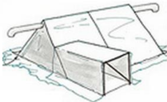
図19 最後に、シェルター全体を約18インチの土の層でカバーします。塹壕を掘ったときの土だけでは足りないかもしれません。十分な土を確保するために、塹壕をより深く掘る方法もあります。その場合は、ここに書いてあるデザインを変更する必要があるかもしれません。
