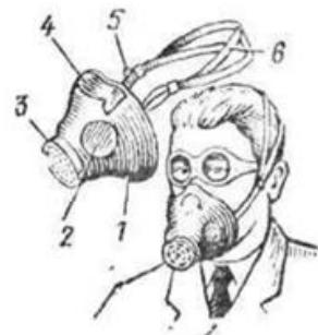
図 15. R-2保護マスク; 1 ハーフマスク, 2: 吸気弁, 3 排気弁, 4: ノーズクリップ, 5: しめひも, 6: 頭部
